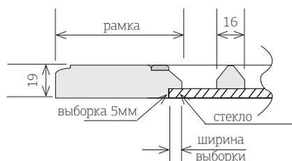
схема для полурешетки с узкой перемычкой
